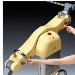
動かしたい方向へ操作レバーを動かすとアームを自分の腕のように動かせる技術「ハプティックインターフェイス」を採用しています。
